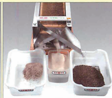
荒挽粉、そば粉、そば殻、一度に三分別します。 荒挽粉は再製粉して仕上げます。
